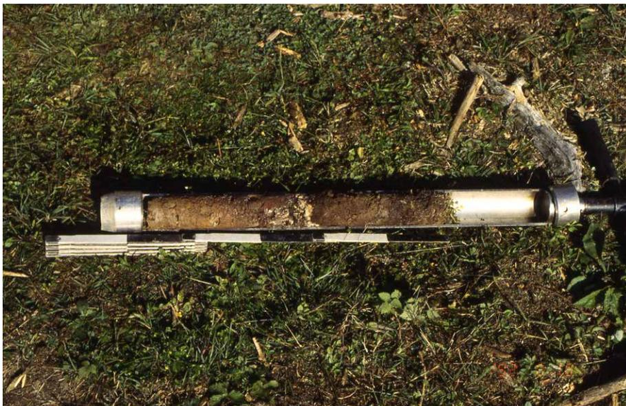
Abb. 3.6: Beprobung eines Bodenprofils in Quadrant 10.
