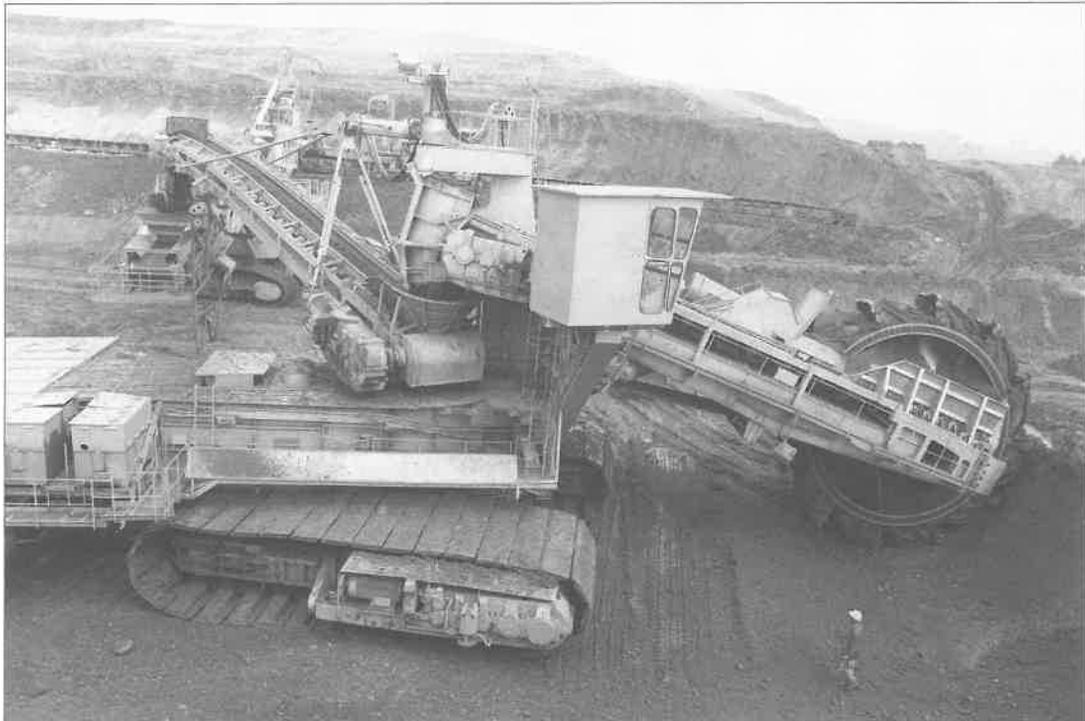
*Schaufelradbagger im „Großtagebau Oberdorf“ der GKB*
