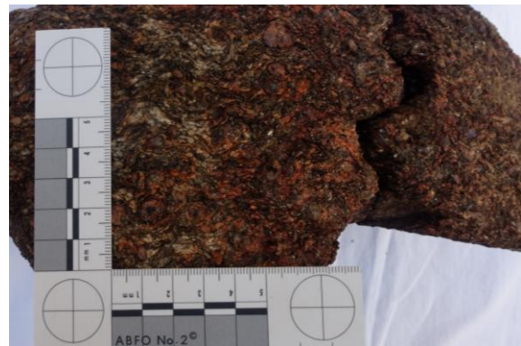
Abb. 36 - Detail Gleisdorf_2017_364-2: Besteht aus Granat-Glimmerschiefer.
