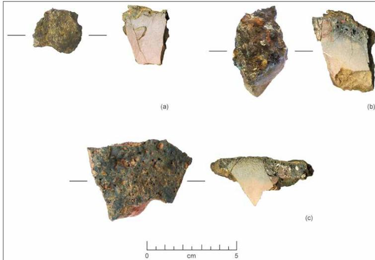
Abb. 6.47: Verschlackte Ofensteine vom Kupferschmelzplatz S1. (a) Probe MA-101390 (FNr. 4941, Ostwand Ofen 1), (b) Probe MA-101399 (FNr. 5476, Ostwand Ofen 2, ältere Phase), (c) Probe MA-101415 (FNr. 4489, Ostwand Ofen 5).
