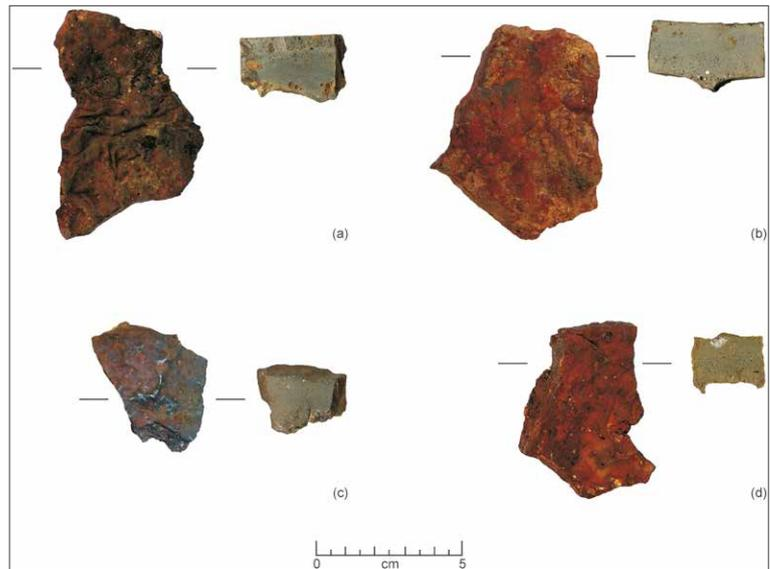
Abb. 6.4: Typische Laufschlacken (Typ A) vom Kupferschmelzplatz S1. (a) Probe MA-091456 (FNr. 696, Halde 1, Schicht 6), (b) Probe MA-092862 (FNr. 2863, Vorplatz Doppelofenanlage 9/10), (c) Probe MA-113472 (FNr. 4160, Vorplatz Ofen 11, Schicht 17), (d) Probe MA-092831 (FNr. 1219, Röstbett 2). Fotos: Steffen Kraus
