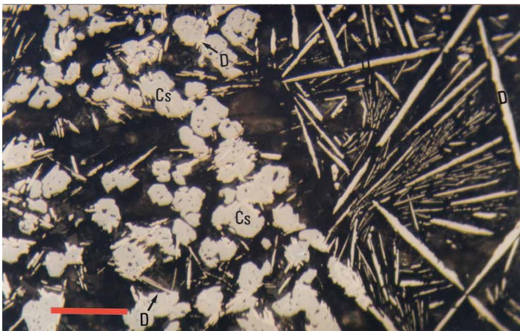
Abb. 3.9: Delafossit (D) als Saum um „Cuprospinell“ (Cs) und als leistenförmige Kristalle. Grundmasse besteht aus kristallinen und glasigen Silikatphasen. Probe 920845 Kupferschlacke, Kupferschmelzplatz S1 (FNR 68, Qu 8). Polierter Dünnschliff, Nicols parallel, Marke = 0.05 mm, Ölimmersion.
