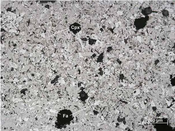
Abb. 6.20: Mikrogefüge des Laufschlackenanteils einer Schlacke vom Typ A+B (Probe MA-091499, FNr. 2078, Halde 2, Schicht 2). Das Gefüge besteht hauptsächlich aus Fayalit (Fa) und Klinopyroxen (Cpx). In den Zwischenräumen können feinkörnige Magnetite (Mag) auftreten. Auflichtaufnahme, Fotos: Steffen Kraus
